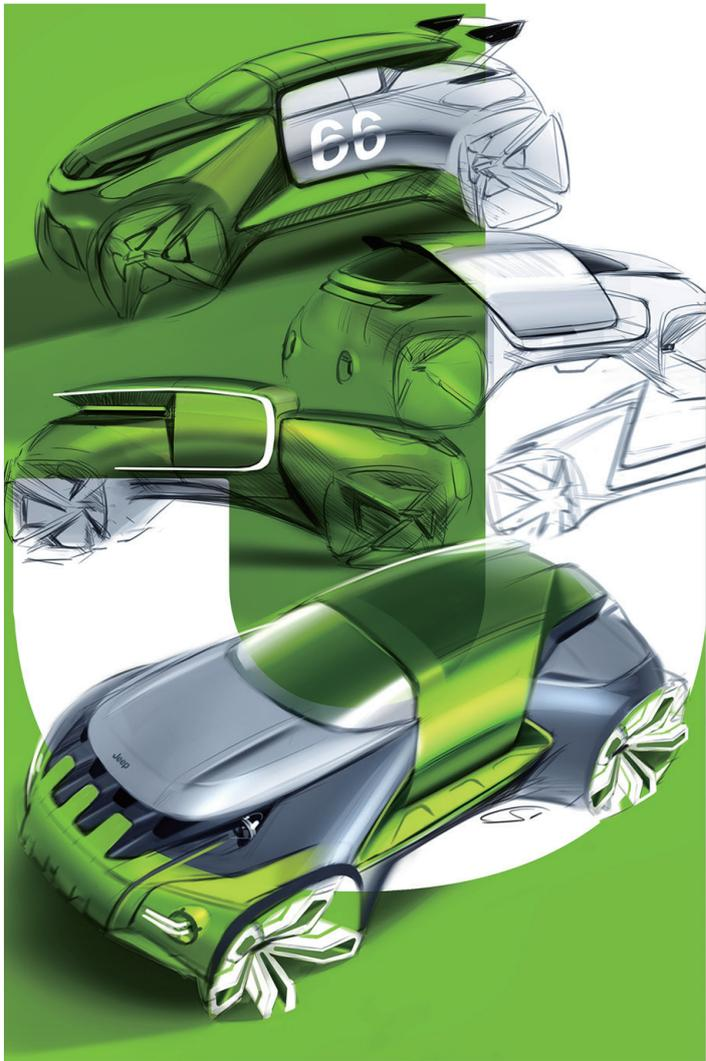
在选出的两三个比较好的设计造型草图的基础上进行方案深化,给产品自身添加更多的细节。这时需要适当注意产品自身应该有的一些结构是否符合基本的工程需求,对产品本身进行基本的材质与颜色的区分。
