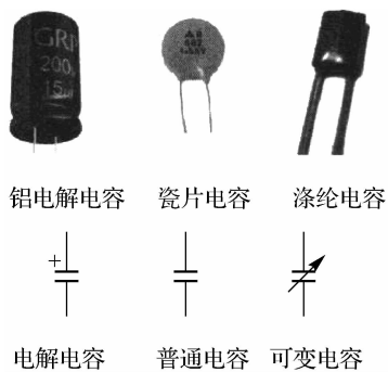
图 1-64 常用电容器实物及图形符号
