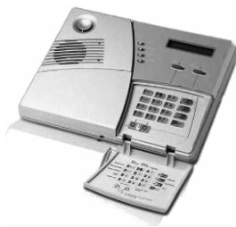
图 1-12 Powermax(PM)无线入侵报警控制器
