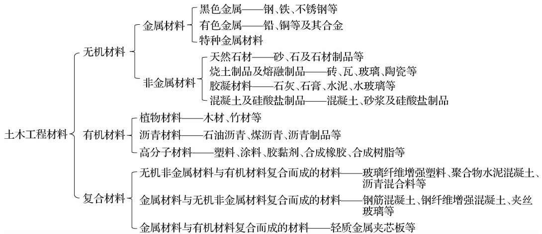
图 0-1 土木工程材料的分类
