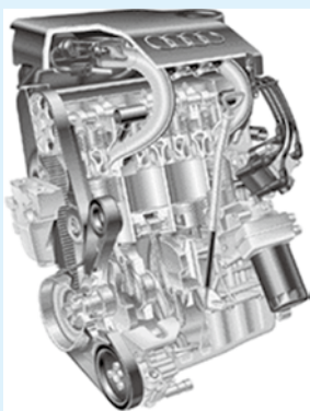
图 1-28 自然吸气（非增压式）发动机
