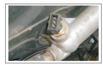
图1-14 冷却液温度传感器
