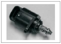
图1-25 怠速步进电机
