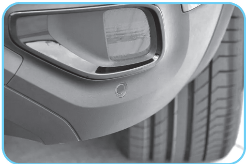
◎图 1-12 汽车倒车雷达
