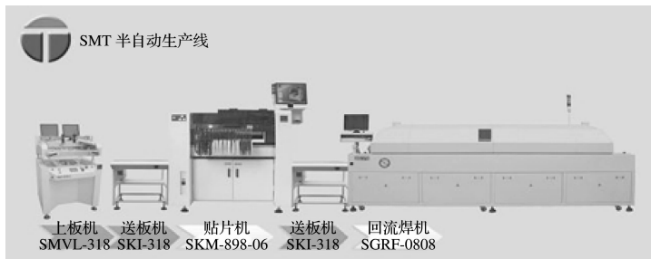
图 0-8 SMT 设备示意图
