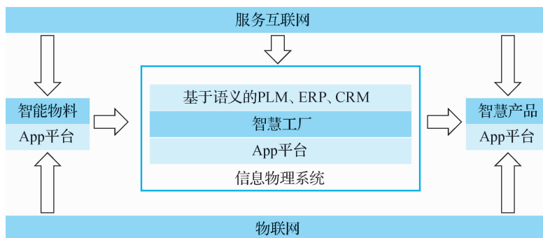
图 1-1 智能制造技术体系的框架
